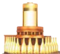
ggf. Zugabe der Dosage (liqueur d'expédition) zur Bestimmung des Süßgrades
